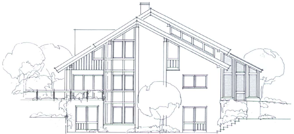
Südfassade des Niedrigenergiehauses in Lörrach mit den charakteristischen Luftkollektoren zur hybriden Sonnenenergienutzung.
