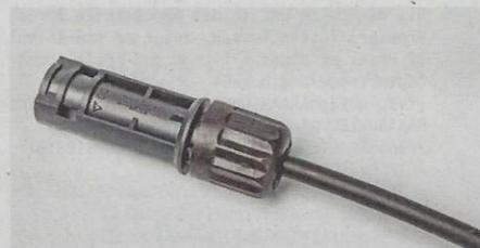
**Fertig:** Bevor man den Stecker von vorne auf die Hülse steckt, müssen Schraubkappe und Zugentlastung eingefädelt werden. Am Ende beide Teile verschrauben.
